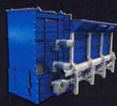
Aufgabe- und Dosierbunker
