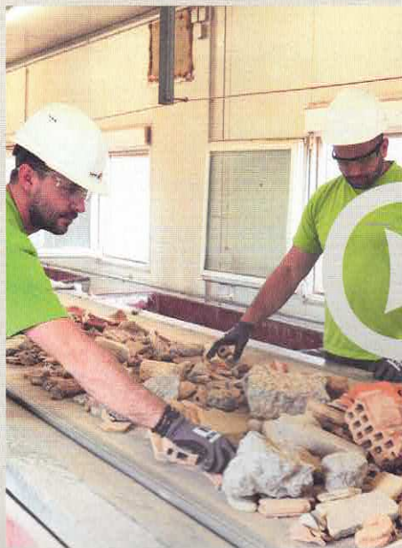
Aussortieren des Bauschutts
