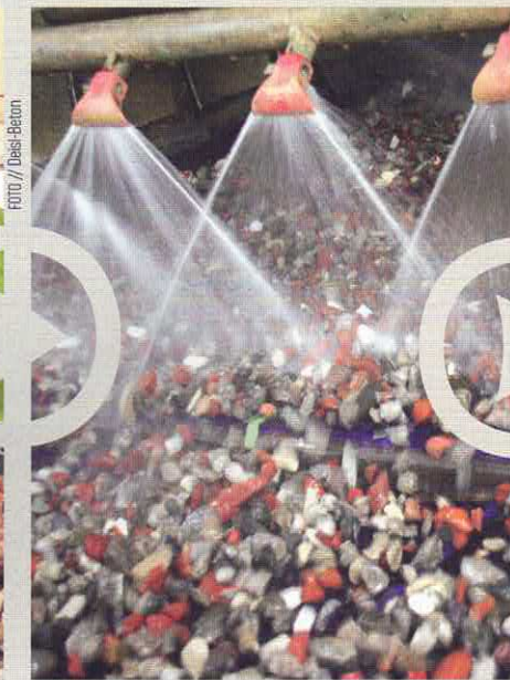
Waschen des zerkleinerten Materials
